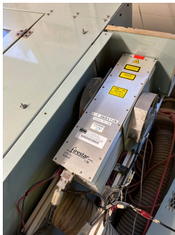
レーザー加工機の発振器 (内部に充填しているガスを再充填)
