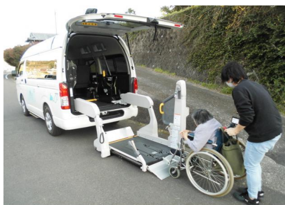
リフト使用中の写真
