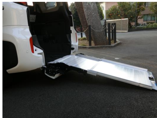
乗降用スロープ側面
