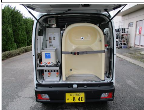
ボイラー、浴槽等搭載
