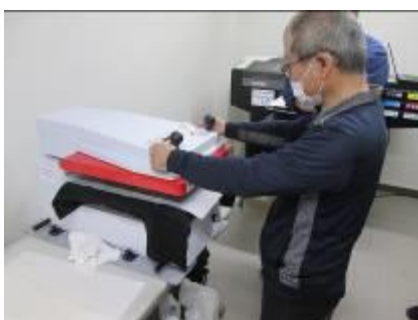
高温でプレスして布に印刷した絵柄を定着させている様子
