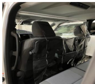
飛沫防止シート装着写真
