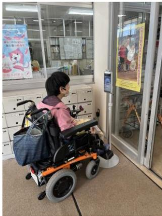
サーモカメラ・・作業所への入り口の所で使用することで、体調不良者の所内への侵入を防ぐことができる。
