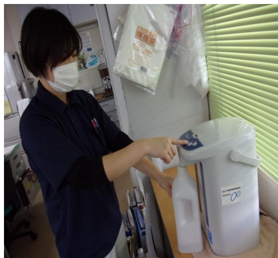
電解次亜塩素酸水生成器 (生成の様子)
