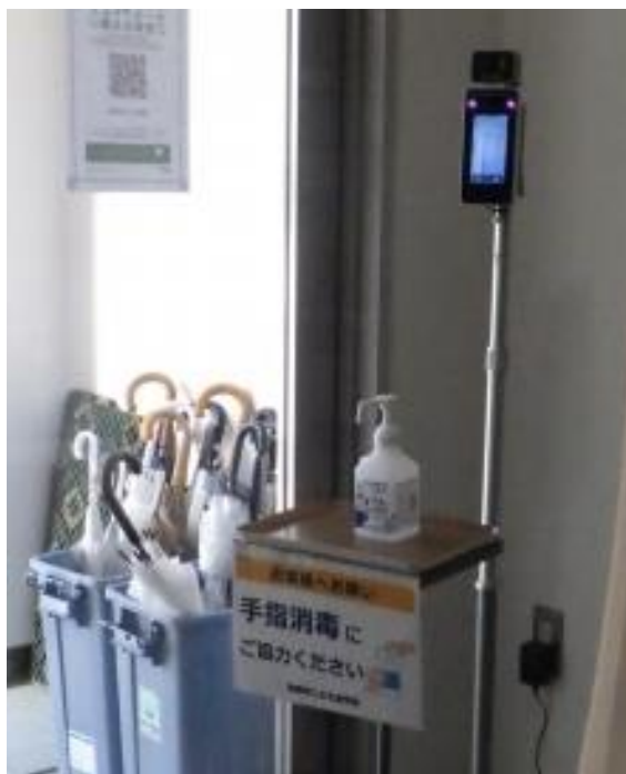
・通用口に設置したサーモカメラ
