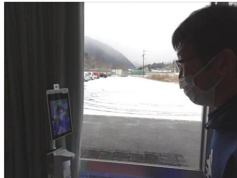
サーモカメラは職員出入口に設置。出勤時の確実な検温を実施し、施設に菌を持ち込むのを防ぐ。
