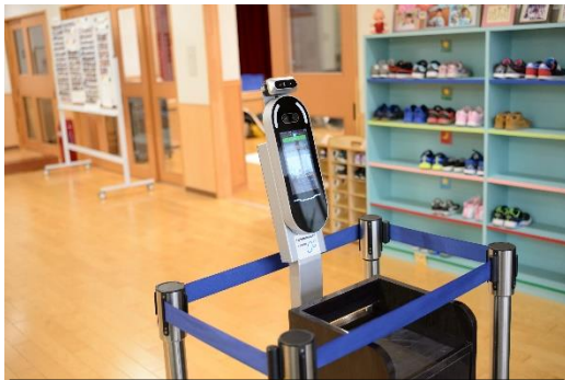
玄関に設置したサーモセンサー
