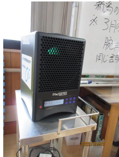
上部でUVランプと光触媒反応により、過酸化水素イオンが発生しています。
