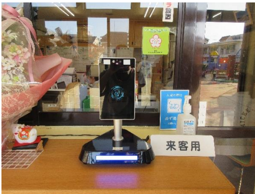
サーモカメラ正面写真 1
