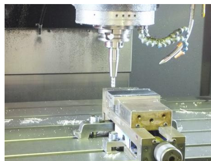
現場の装置による切削性能実証実験
