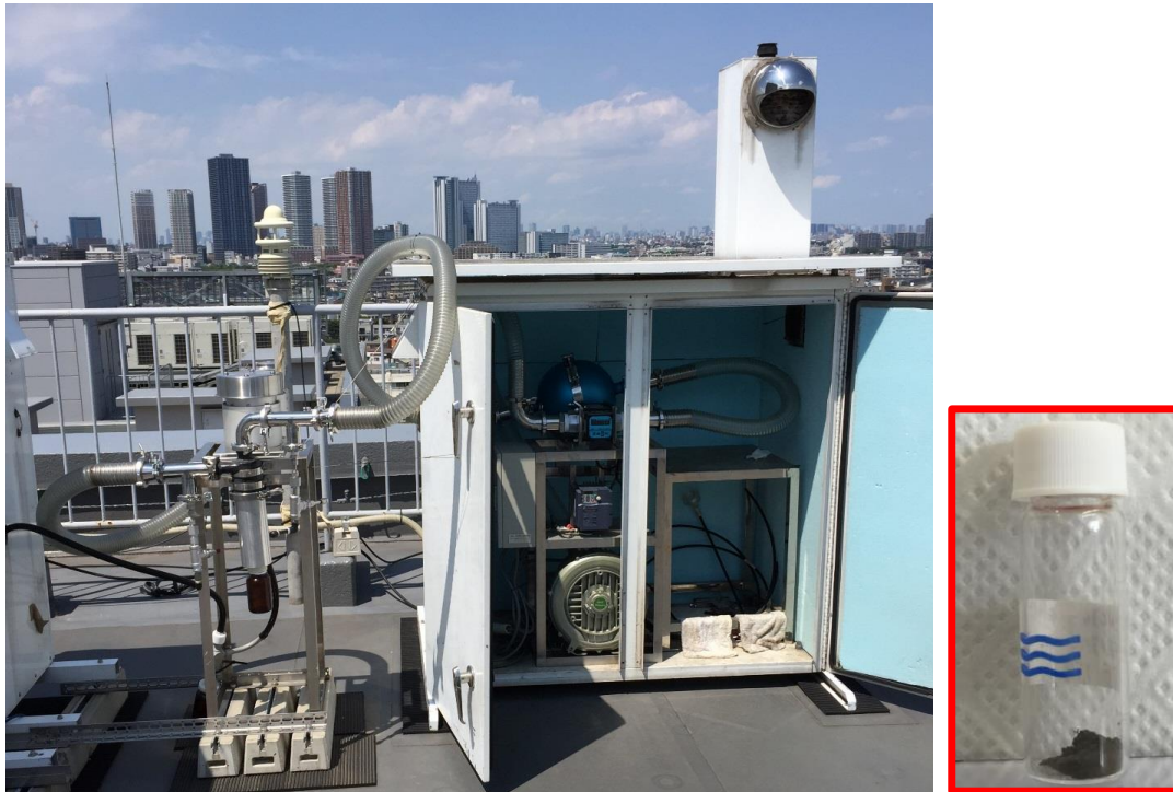
▲製作したPM 2.5 と黄砂粒子の大流量採取装置と採取された粉体試料
