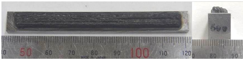
図7 積層ビード外観 (600 mm/min)
