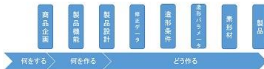
付加製造によるものづくりの流れ
