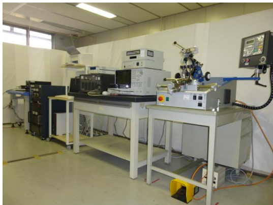
磁気特性測定装置全体
