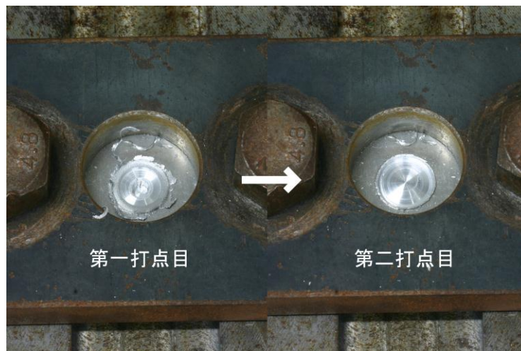
図3 穴を消失させた摩擦攪拌点接合試験片
