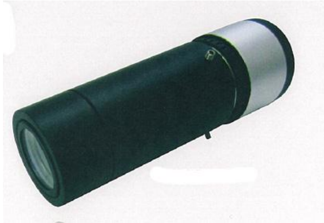
図3. 試作した広角中心窩望遠鏡概観
