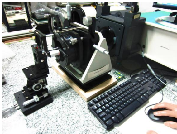
図4 光学性能評価用装置(MTF測定用)
