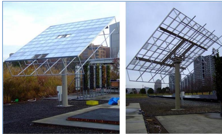
実施項目-2 実験装置 外観写真 (太陽光追尾装置)
