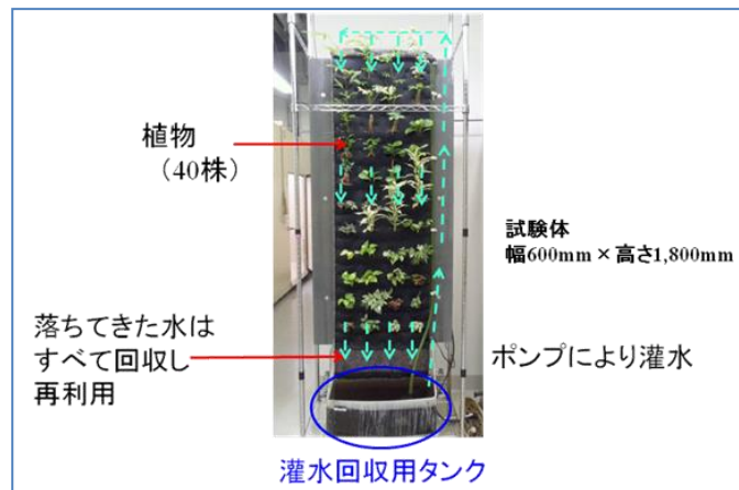
実施項目-5-1 室内緑化試験体
