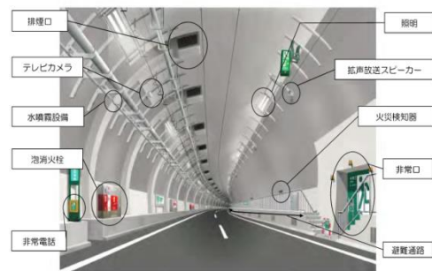
図 トンネル内防災設備のイメージ
