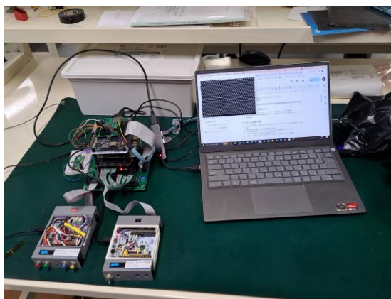
図2: ミッションオンボードコンピュータ(MOBC)の試験システム。今後このソフトウェアを図1のハードウェアに移植していくことになる。
