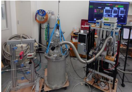
図1 高温超電導用水素冷却システム一式 図2 実施機関における冷却実験の様子
