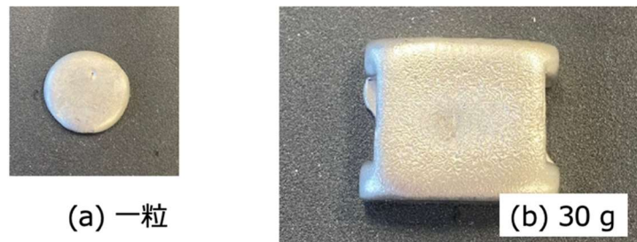
図2 注入装置を介して鑄型で作成したインゴット, (a) 一粒 (2.0 g), (b) 30 g.
