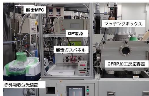
図 1. 本助成で整備した CFRP 加工機
