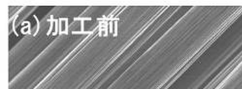
図8. CFRPをO 2 プラズマ加工前後のカーボンファイバの外観
