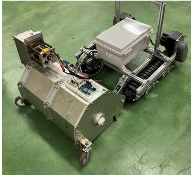
図1 開発したフレイル型草刈システムの外観
