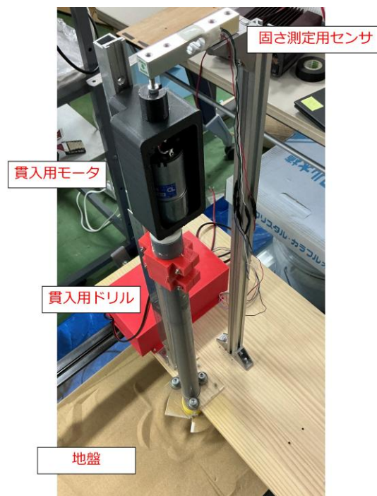
図2 土壌固さ実験装置の外観
