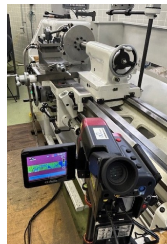
図1 サーモグラフィーによる切削表面温度の可視化測定の様子
