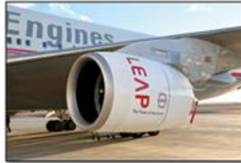
図4 エンジンメーカーのエンジン保守の認証取得を目指す。写真はTiAlタービンプレードをタービン後段に適用したLEAPエンジン
