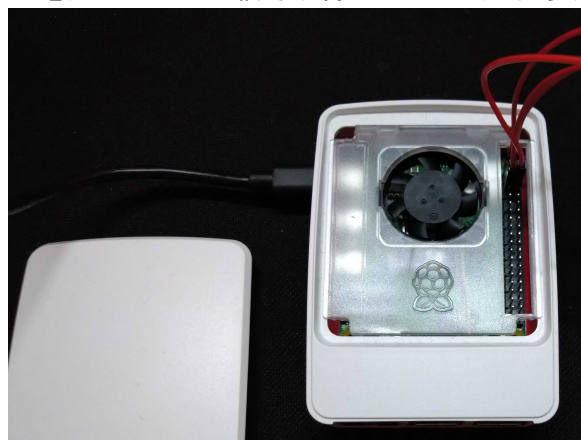
図3 本補助事業で作成したラズベリーパイによるセンサ信号取得システム
