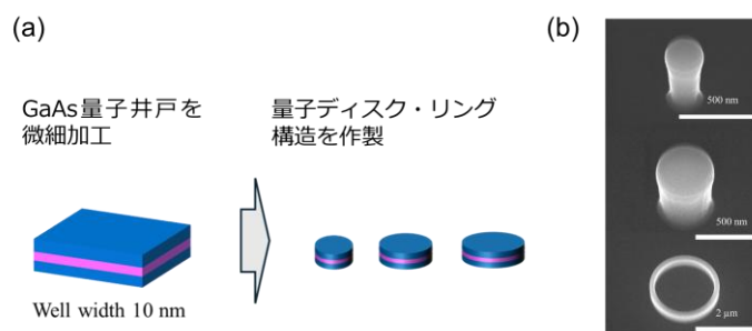
図1: (a) GaAs/AlGaAs量子井戸を微細加工し、量子ディスク構造を作製した。(b)エッチング条件を最適化した後に作製したGaAs量子ディスク・リング構造。
