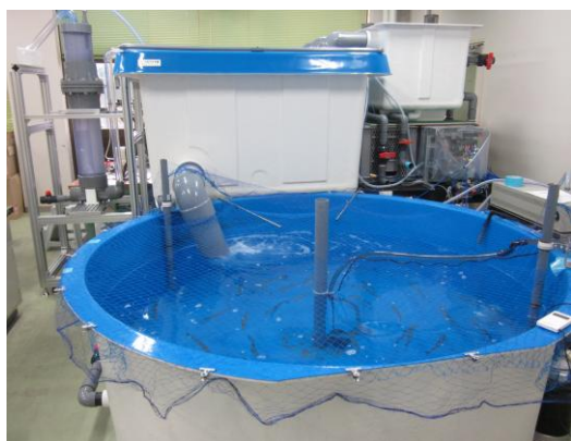
オゾン浄化技術, RAS-ME, 水温制御装置 を搭載した閉鎖循環式陸上養殖システム
