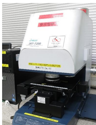
顕微IR法を用いたプラスチック成型品の結晶化度測定
