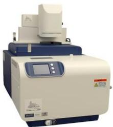
【用途】有機物やプラスチック、セラミックス、金属材料の融点、ガラス転移点、結晶化、硬化点などを測定する装置です。
