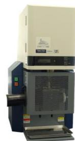
【用途】試料温度を変化させながら、試料の寸法変化を測定します。線熱膨張率やガラス転移点などを測定する装置です。
