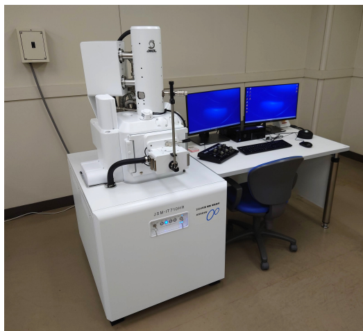
分析走査電子顕微鏡 (JSM-IT710HR 日本電子株)
