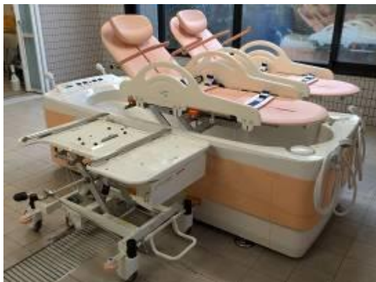
ストレッチャーから担架を外して浴槽に ドッキングした状態
