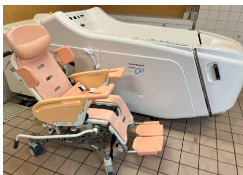
特殊浴槽(車椅子式機械浴槽)
