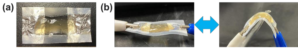
図5. (a) 作製したデバイス (b) 曲げ動作
