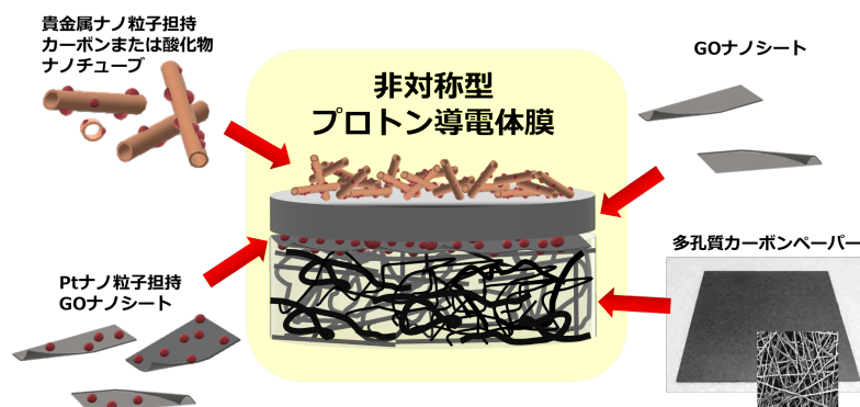
非対称型プロトン導電体膜の構造と構成材料
