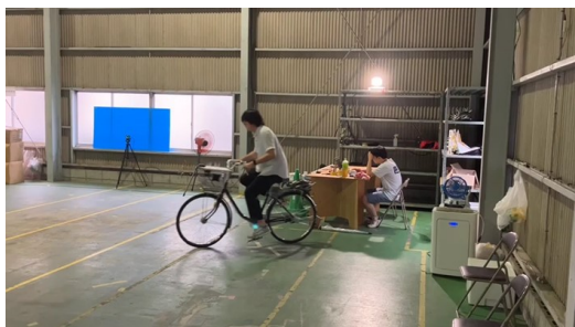
図 3. 自転車の動特性とふらつきモデルのパラメータ推定実験の様子
