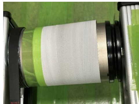
図2 ペイント帯電材のローラーへの実装
