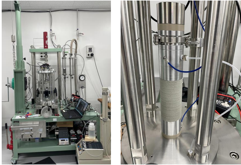
図 1 開発した試験装置の全体と供試体の設置状況
