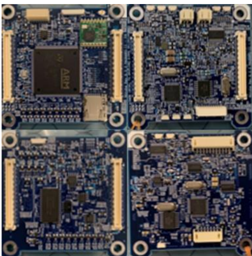
図6 開発した通信・情報処理基板
