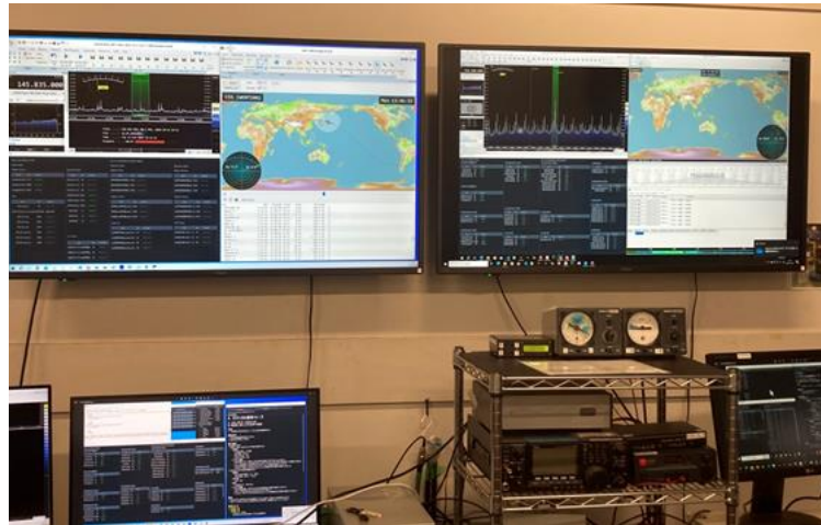
図 8 衛星間通信におけるテレメトリ受信確認試験の様子
