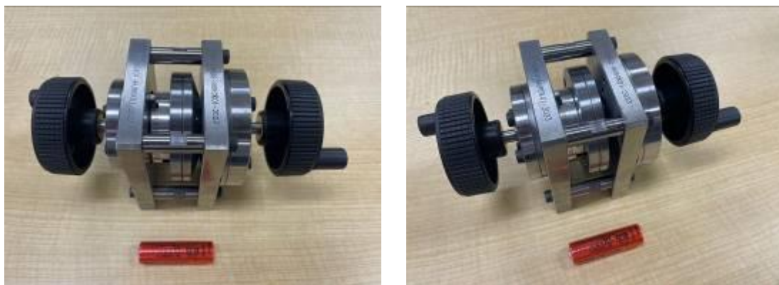
図1 セルフロック機能を有する減速機構(ロッキングギヤ)試作初号機
