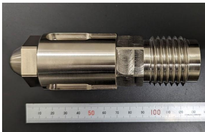
図2 双曲線穴形状を有するダイを挿入した射出ノズル
