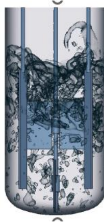
図—4 ワイドパドルのスケールアップ計算（流体：水，槽内径2m, 回転数90rpm）
