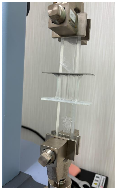
図 3 ZB ハイドロゲルによるガラス・ステンレス間の接着・伸長
