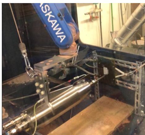
図1 低圧コールドスプレーガンによるアルミニウム皮膜の成膜の様子
