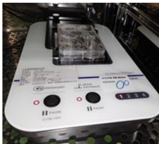
図 5 : 本補助金で購入した培養器内 (湿度 100%) 用の特殊顕微鏡。細胞が増殖していく様子を数値化できるため、臓器チップの評価に適している。
