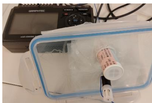
図 4 : 本補助金で購入した温湿度・CO 2 測定器。これらを、臓器チップを囲う培養ボックスの蓋に取り付けた。
