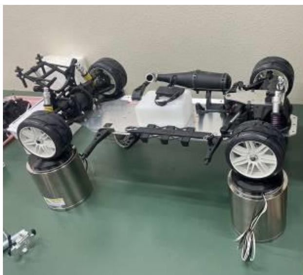
図5. 車体加振実験装置
